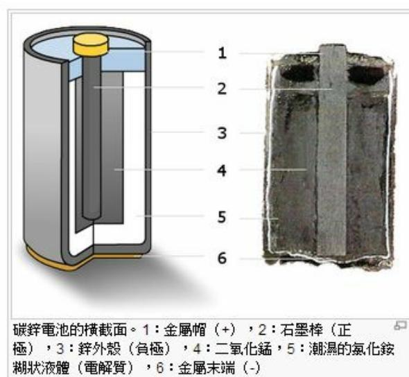
圖、碳鋅電池的反應式、實體與結構
