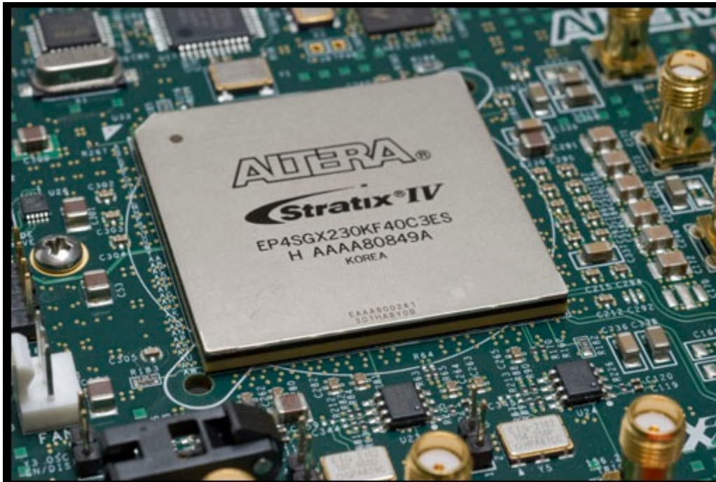
圖、Altera StratixIVGX FPGA
